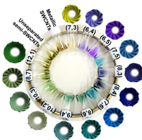
図3 Overloading 法で分離した 12 種類の単一構造 CNT [14]
