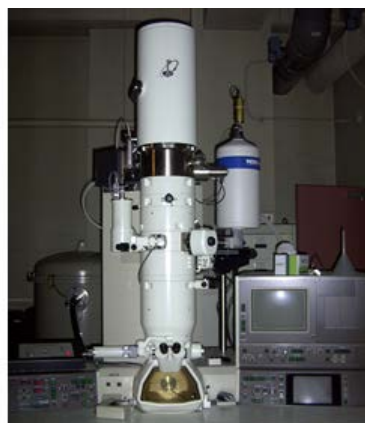
単層カーボンナノチューブの模式図と透過型電子顕微鏡
