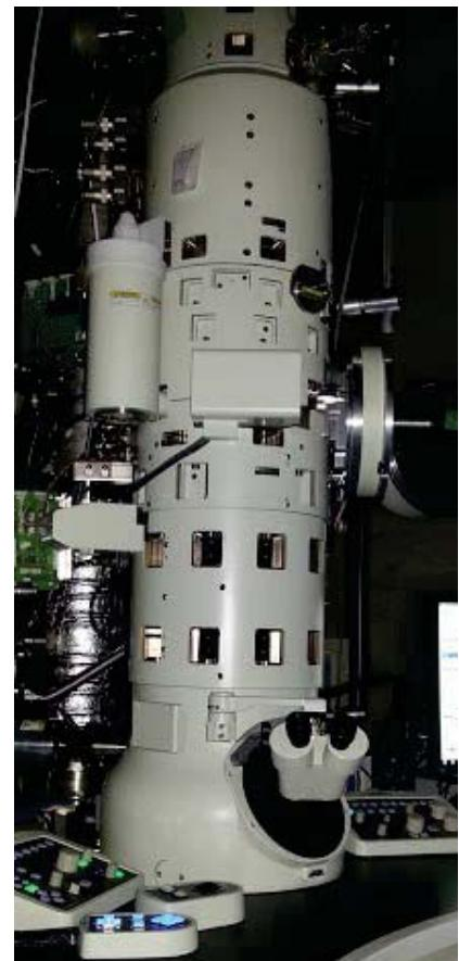
図 6: 現在開発中の原子分解能無磁場電子顕微鏡.
