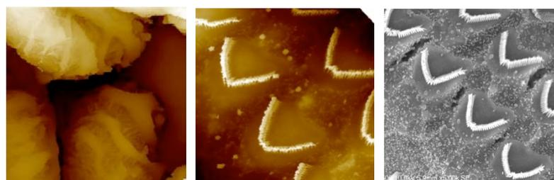
図 3 走査型イオンコンダクタンス顕微鏡画像 (左・中央)と電子顕微鏡画像 (右)
