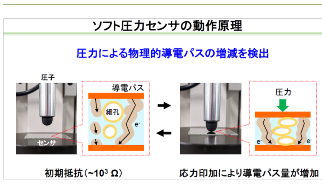
図3 ソフト圧力センサの動作原理
