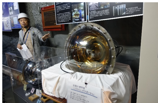
(図5) チェレンコフ光を捉える世界最大の 直径 50 cm の光電子増倍管
